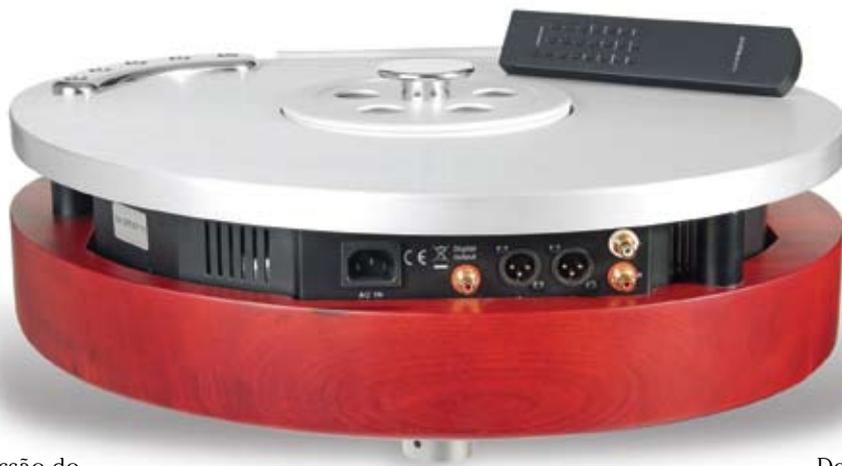
remoto metálico que o acompanha. As conexões encontram-se na parte posterior do *player*: dois conectores RCA, dois XLRs, uma saída digital SPDIF e a entrada IEC fêmea para cabo de força destacável. Como os cabos devem passar entre o alumínio e a madeira para atingir os conectores (41 mm), poderá haver dificuldades se forem utilizados cabos grossos ou com conectores largos. Durante o teste, não foi possível utilizar o cabo de força **Eternity** da **Logical Cables** por esse motivo.
